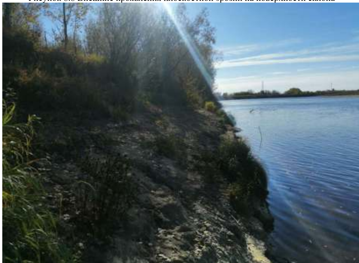
Рисунок 8.9 Внешние проявления плоскостной эрозии на поверхности склона и суффозии в основании склона
